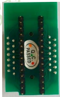
SOP-28和SOP-20的转换座(反面)
