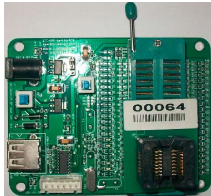
SOP-16转换座的安装
