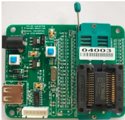
SOP-28转换座的安装
