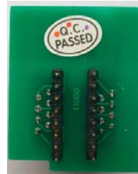
SOP-16和SOP-8的转换座(反面)
